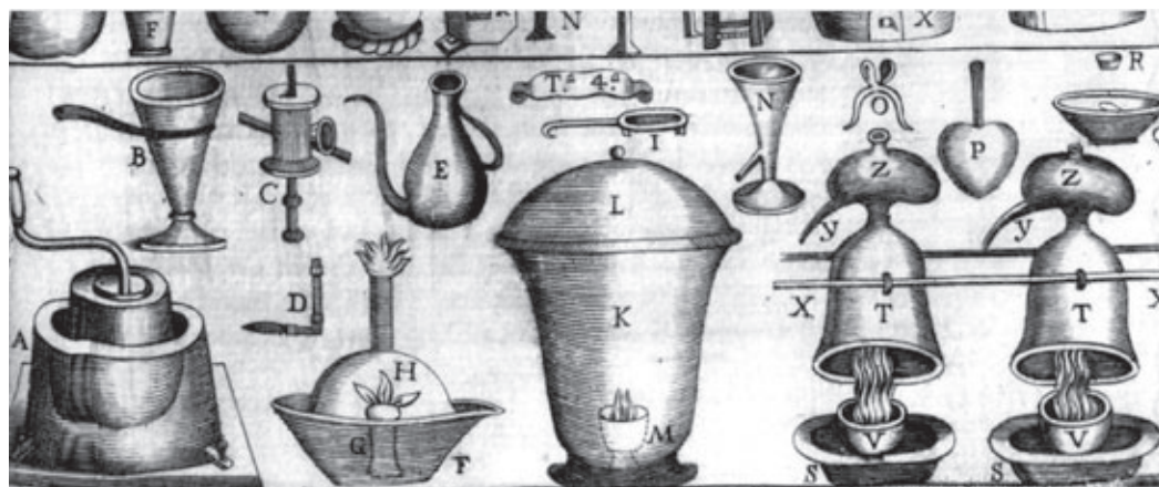
Fig. 3 – Utensili da laboratorio necessari per la produzione di pillole e tazze di antimonio cioè: Vaso di Ferro detto Cornetto per far il Regolo d'Antimonio e simili (B), Molla per far le Tazze di Regolo d'Antimonio (C), Formula per le Pillole perpetue che si fanno col Regolo d'Antimonio (O). Corso di chimica del signor Nicolo Lemery (Bologna, Longhi, 1717).
